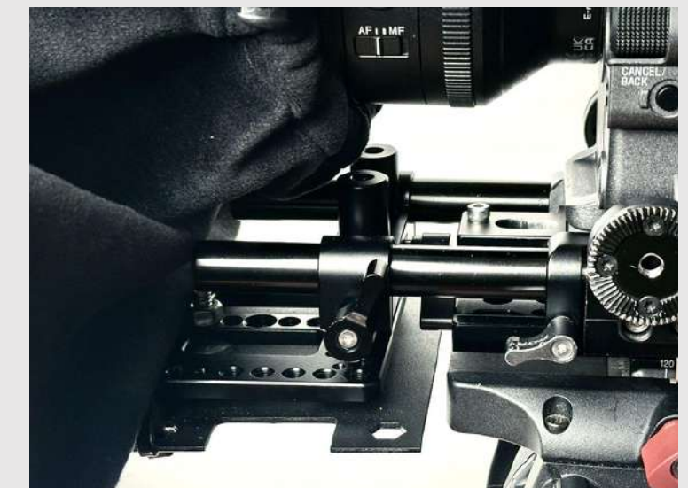
se conecta a barras de 15mm
